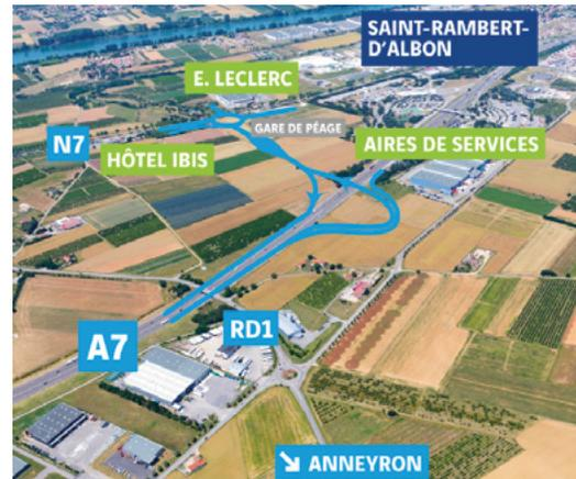
**Le demi-échangeur Nord**, orienté au Sud se raccorde à la RN7 au Sud de l'aire de services de Saint-Rambert-d'Albon. Ses bretelles se raccordent à la RN7 via un carrefour giratoire à créer. Cet aménagement est composé d'un nouvel ouvrage franchissant l'A7 et d'une gare de péage bidirectionnelle et nécessite la reprise de l'ouvrage d'art de la RD1.
